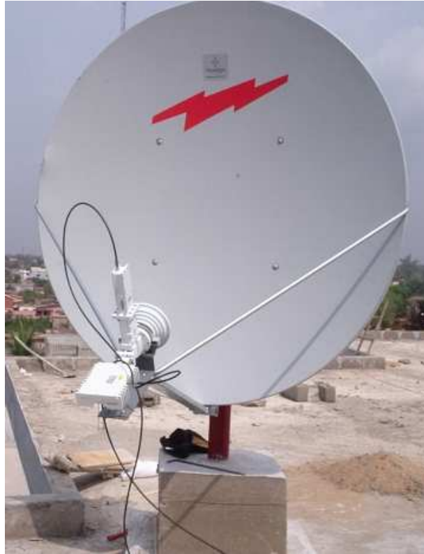
Photo d'exemple : Antenne Bande C sur notre service AMC-12
